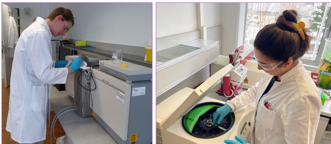
Figure 16 Mesure d'une PSD à l'HSLU : à gauche diffraction laser, à droite centrifugeuse optique.
